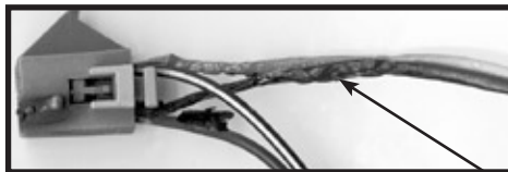
Remarquez que l'isolant du fil n'est fondu qu'à proximité du connecteur.
